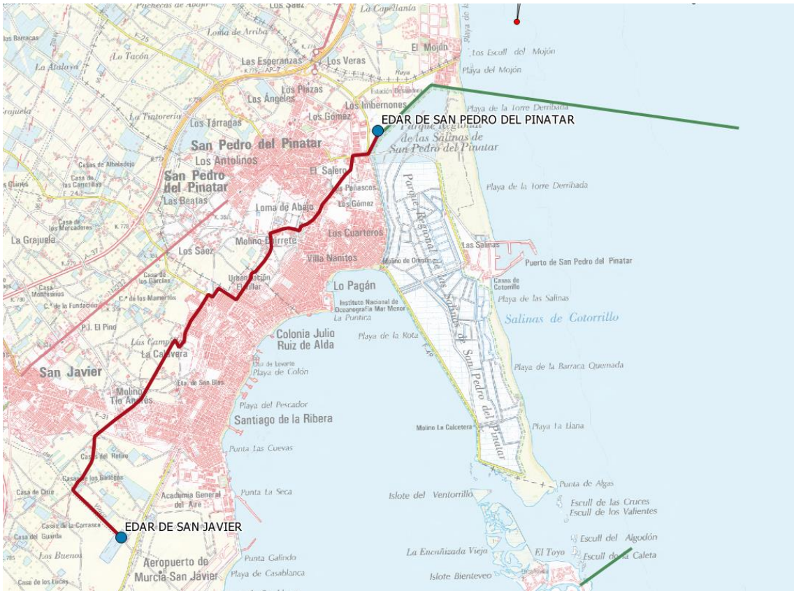
Tubería existente (granate) de conexión entre las EDAR de San Javier y San Pedro del Pinatar, emisario existente (verde) de conexión desde la EDAR de San Pedro del Pinatar con el mar Mediterráneo.
